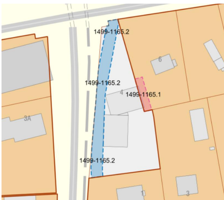
Figur 10 visar fastigheten Floby 15:19 samt den ledningsrätt och ett av de servitut som finns inom och i anslutning till fastigheten. Förutom dessa finns även ett servitut för en utfartsväg som sträcker sig likt ledningsrätten.
